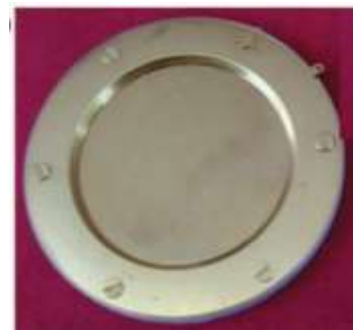
Diamond detector ( \phi 46 mm \times 300 \mu m)
